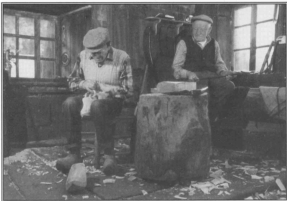
Arrotondamento dell'orlo dell'imboccatura con il coltello a lama fissa.
